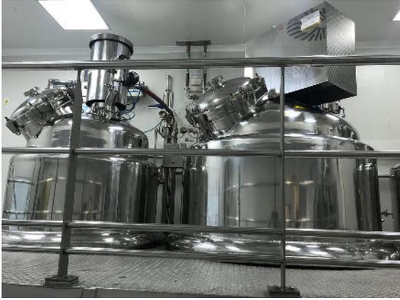
Equipo de fabricación para la mezcla homogénea de productos en dispersión a temperatura controlada. Especialmente diseñado para aplicaciones en industria Farmacéutica, Cosmética y Alimentaria.
